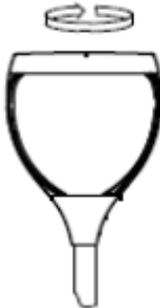
5. Faire pivoter le luminaire à l'orientation désirée et appliquer un joint de silicone pour obtenir un joint imperméable entre le luminaire et le fût.
