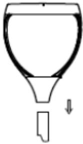
4. Glisser le luminaire sur le tenon ou le fût d'un diamètre de 2-3/8 po.
